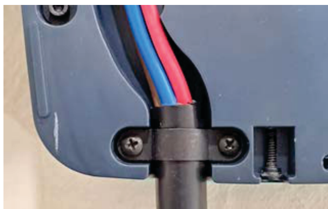
Figura 3: Sujeción del cable de alimentación
